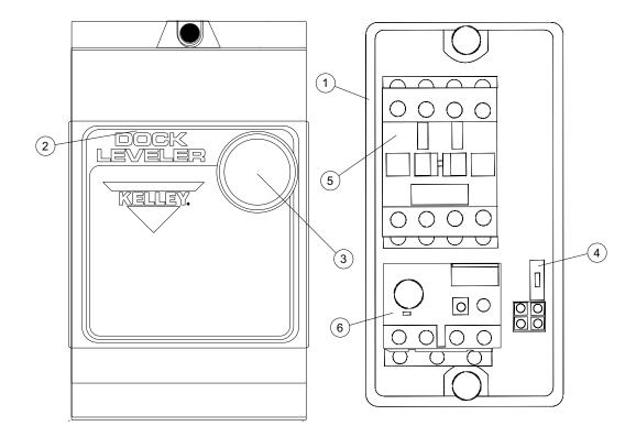
PARTS LIST, continued CONTROL BOX ASSEMBLY — STANDARD 6006450 — 208-240V, 3PH, 60 HZ 6006451 — 460-480V, 3PH, 60 HZ 6006452 — 575V, 3PH, 60 HZ
