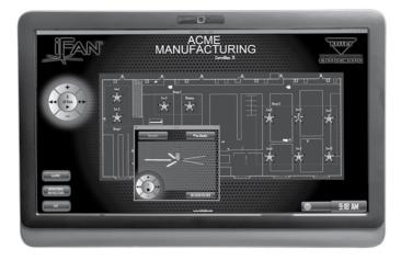
A caixa de diálogo para um só ventilador fornece acesso às configurações de direção e velocidade de um ventilador específico.
